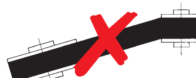
Défaut de parallélisme des arbres
